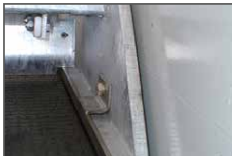
Breite und hochgezogene Seitenkufen angeschraubt
