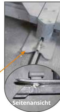
Breite Auflage für Mittelbock, Rundeisen angeschweißt
