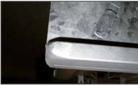
Auflagefläche der Seitenkufe abgerundet
