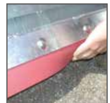
Gummilippe: gutes Räumergebnis und bedenkenlos auf Gummi einsetzbar
