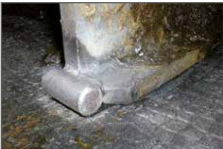
Seitenkufen mit Rundeisen und breiter Auflage
