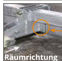
Räumklappenanschlag: kein Bodenkontakt
