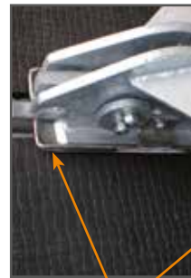
Breite Auflage für Mittelbock, kufenförmig hochgezogen
