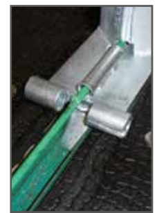
Breite Auflage für Mittelbock, Rundeisen angeschweißt
