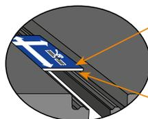
para la colocación suelta, ajustar la distancia entre colchón con la ayuda del útil (que es más ancho que el perfil)
