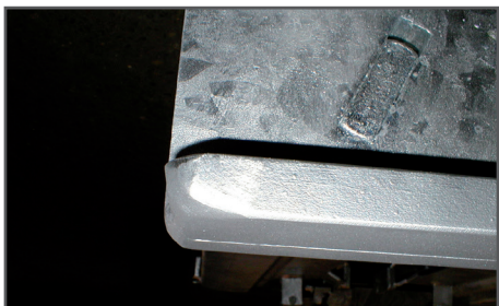
закруглить опорную поверхность боковых полозьев
