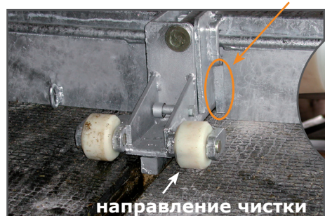
центральная часть на широких пластмассовых роликах
