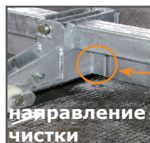
Стопор скребков: исключить контакт с поверхностью пола
