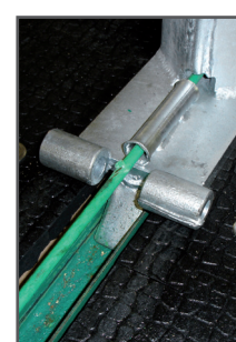
широкая опора для центральной части, приварен пруток
