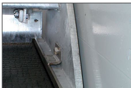
закрепленные широкие и приподнятые боковые полозья
