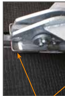
brede steunvlakken voor de trekslede met ronde opstaande rand
