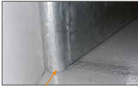
zij mestkleppen let op: scherpe kanten (-> afronden)
