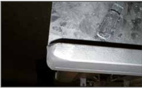
de steunvlakken van de glijvoet zijn afgerond
