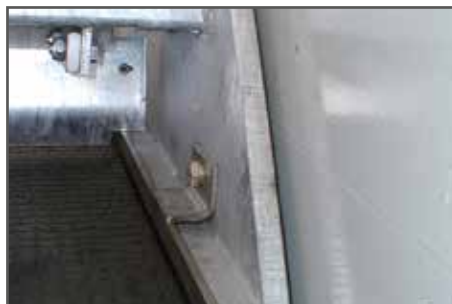
opgeschroefde brede en opstaande glijvoet
