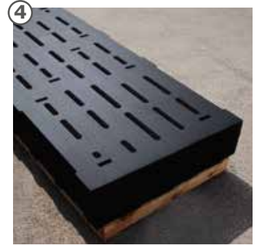
3 overeenkomend met de CAD tekeningen worden de sleuven d.m.v. waterstraal-snijtechniek passend in de matten gesneden
