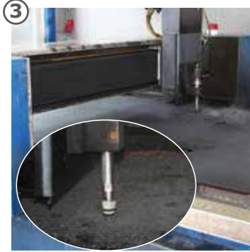
3 overeenkomend met de CAD tekeningen worden de sleuven d.m.v. waterstraal-snijtechniek passend in de matten gesneden
