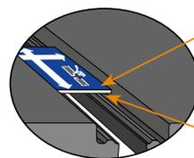
Für die lockere Verlegung Mattenabstand mit Hilfe der Montagelehren (breiter als Profil) einrichten
