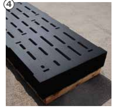
3 CAD tarafından yapılan çizimlere uygun olarak su jetleri ile kauçuk kesimleri yapılır
