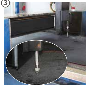
3 CAD tarafından yapılan çizimlere uygun olarak su jetleri ile kauçuk kesimleri yapılır
