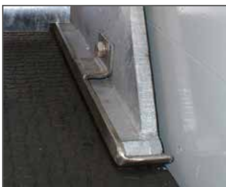
opgeschroefde brede en opstaande glijvoet
