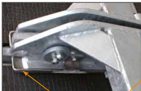
brede steunvlakken voor de trekslede met ronde opstaande rand
