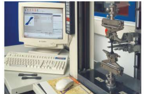
橡胶抗拉力检测
