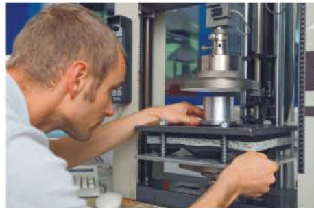
橡胶耐磨性能检测
