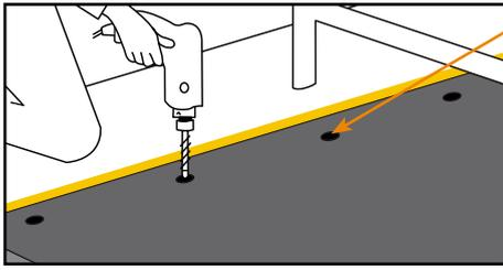
Am vorderen Rand durch die vorgefertigten Befestigungspunkte befestigen
