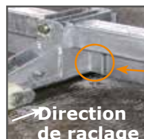
Butée de volet : pas de contact avec le sol !
